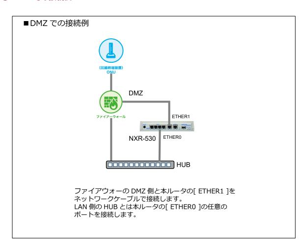
NURO アクセスまたはフレッツ光の複数グローバル IP アドレスサービスをご利用の場合、ファ イアウォールなどの機器を DMZ 構成にすることで、DMZ 上に本ルータを接続することができま す。
