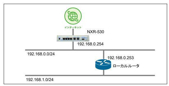
※ リモートアクセスで社内にアクセスするクライアントは、納入時の初期コンフィグにより、 本ルータの LAN 側インターフェースで NAT により送信元 IP アドレスがすべて、本ルータ の LAN 側 IP アドレスに変換されます。
